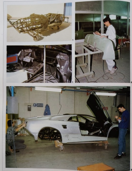
1. Le châssis, produit à l'extérieur, est plus rigide et plus simple que celui de la Countach et comporte des zones d'absorption. 2. La carrosserie est en majeure partie en aluminium, à l'exception du toit qui est en acier. Les capots, les portes et les bords de caisse sont en composites. Le tout est ajusté et soigneusement préparé avant peinture. 3. Les composites employés sur la Diablo montrent eux aussi un progrès. Ils sont à la fois plus légers, plus fins et plus résistants et leur production est désormais assurée par un équipement automatisé. 4. Pour la finition, rien ne remplace le contrôle rigoureux et la main de l'homme. 5. Les moteurs sont toujours assemblés individuellement mais l'ajout des pièces, plus précises, est automatisé. 6. Le montage final, dans son procédé, est comparable à celui de la Countach. Ce ne sont pas les cadences infernales même si la productivité est en hausse.
