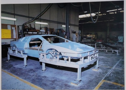
Il faut deux heures pour que l'amalgame synthétique se solidifie en une couleur bleue. Cette coque bruite va maintenant passer au ponçage et à l'ébarbage.
