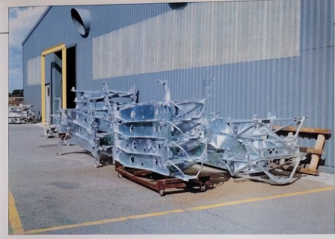
Les châssis ne sont plus galvanisés comme il y a quelques années mais simplement recouverts de polyuréthane. Ils sont entreposés dehors par tous les temps.
