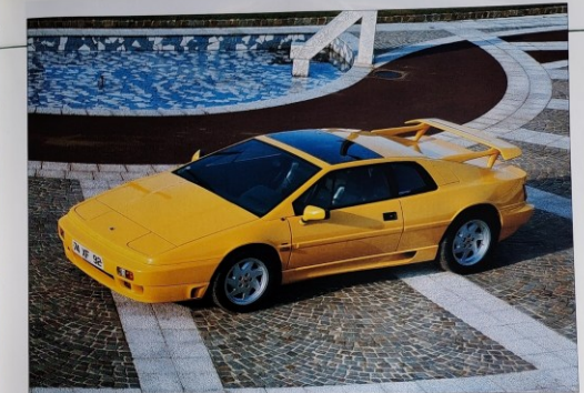
Évidemment, la nouvelle Esprit s'est d'abord un aileron relevable aux bords de fuite agrandis, des ailes arrière plus massives et une lame de spoiler pour accroître la déportance.
