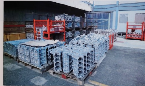
Les blocs moteurs en alliage d'aluminium sont fondus chez un sous-traitant mais usinés et assemblés sur place. Il s'agit du type 907 conçu par Alex Barr, un ancien monteur de Concorde-Climax qui s'inspira d'une base Vauxhall. Né en 1971, il fut d'abord monté par Jensen sur sa Healey avant d'équiper la nouvelle Elite.
