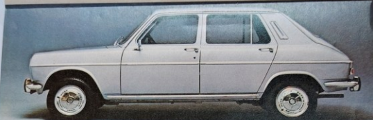
1100 GLS. 6 CV 1118 cm 3 60 CH DIN 160 km/h. Traction avant. Moteur transversal. Banquette arrière rabattable, 2 e porte. Freins avant à disque. et servo-frein. Sièges couchettes. Moteur à allume-cigare. Sur option : boîte semi automatique. Version commerciale exonérée de la taxe sur les voitures de société. Photo 1100 GLS
