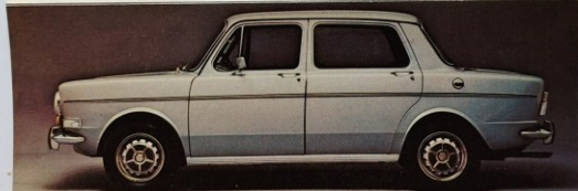
1000 Spécial. 6 CV 1118 cm 3 53 CH DIN 150 km/h. Freins à disque à l'avant. Sièges couchettes. Moquette. Console. Phares à sodé. Avertisseur à compresseur. Photo 1000 Spécial
