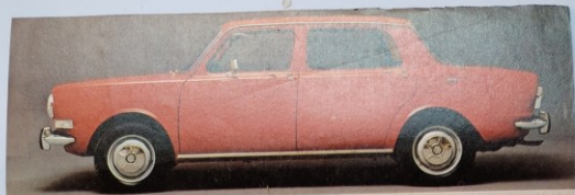
Simca 1000 LS. 4 CV 777 cm 3 33 CH DIN 121 km/h. 5 CV 944 cm 3 44 CH DIN 133 km/h. Sur option : boîte semi automatique. Photo 1000 LS
