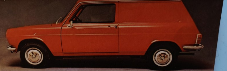
Fourgonnette 1100. 3 places avant. 6 CV 1118 cm 3 54 CH DIN 140 km/h. Moteur transversal. Freins avant à disque + servo-frein. Charge utile : 460 kg. Volume utile : 1600 dm 3 . 7 couleurs. Sur option : boîte semi automatique. Photo Fourgonnette 1100
