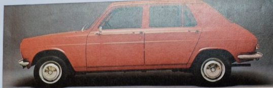
1100 LS. 5 CV 944 cm 3 43 CH DIN 136 km/h. 6 CV 1118 cm 3 50 CH DIN 146 km/h. Traction avant. Moteur transversal. Banquette AR rabattable et amovible, 2 e porte. Freins avant à disque. Sur option : boîte semi automatique (6 CV). Version commerciale exonérée de la taxe sur les voitures de société. Photo 1100 LS
