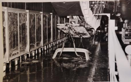
AUTOMOBILES PEUGEOT Électrolyse : Caisse en cours d'immersion Electrolyse : Dipping tank Elektrolyse : Einweichen in das Bad Electrolisis : Cacería en cante de inmersión
