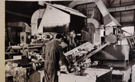
AUTOMOBILES PEUGEOT Mulhouse Fonderie Alu : Machine à couler sous pression de 500 T. Mulhouse Aluminium Foundry 500 Ton pressure casting machine Mulhouse : Aluminiumgießerei Druckgussmaschine 500 T. Mulhouse : Fundición aluminio - Fundidora a presión de 500 tons
